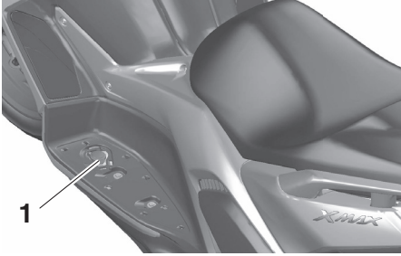
1. Soğutma suyu haznesi kapağı
