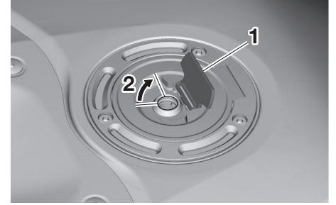
1. Yakıt deposu kilit kapağı 2. Kiliti açma.
