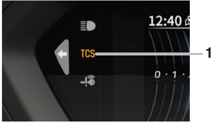
1. Çekiş kontrol sistemi göstergesi “TCS”
